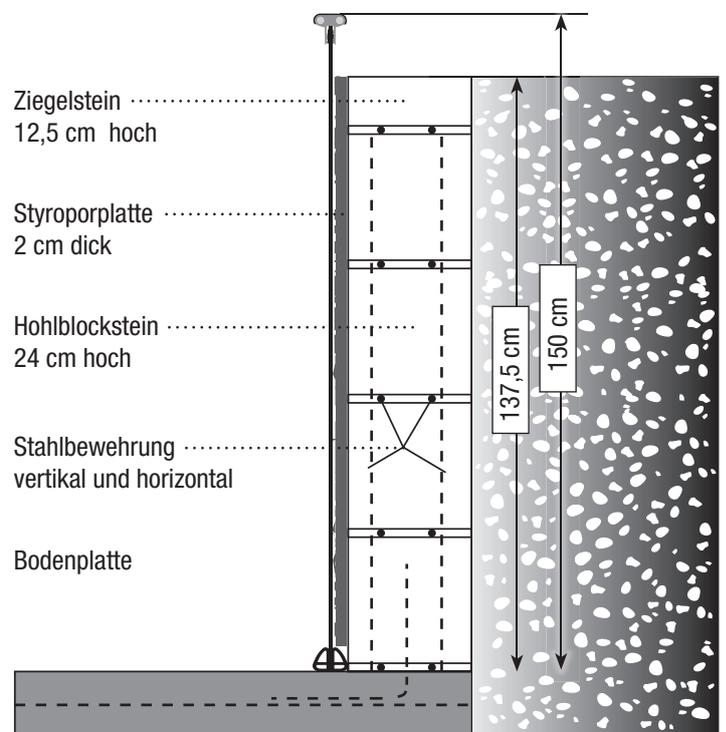
**ACHTUNG: Eine komplette Beckenbefüllung kann erst nach Hinterfüllung der Stützmauer erfolgen!!! Näheres zum Befüllen siehe Seite 9 (Befüllung).**
