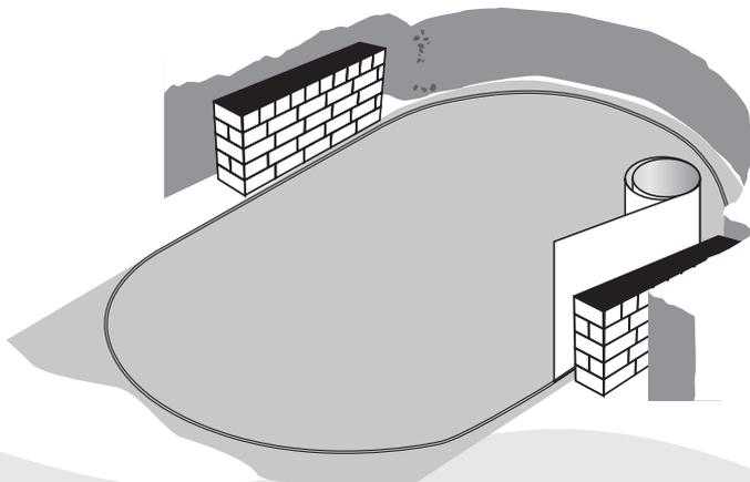
**Wir weisen ausdrücklich darauf hin, dass vor dem Einbau zusätzlicher Einbauteile wie Einlaufdüsen oder Scheinwerfer, die Schnittkanten in dem Stahlmantel zu entgraten und mit Zinkfarbe und Silikon Kautschuk für Schwimmbäder zu versiegeln sind.**
